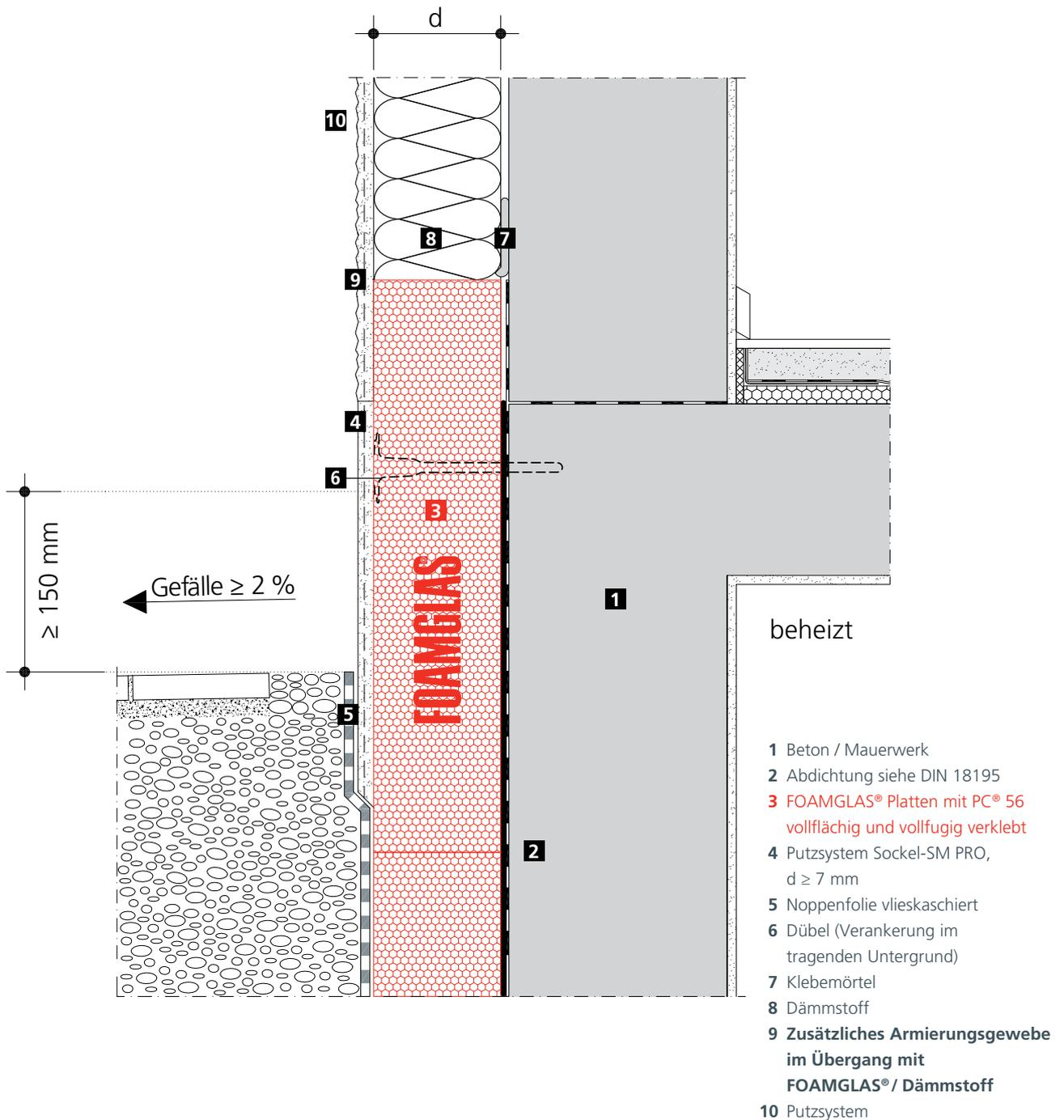
Die FOAMGLAS® Platten vollflächig mit gefüllten und versetzten Fugen mit dem Kaltkleber PC® 56 auf die Bauwerksabdichtung nach DIN 18195 verlegen, Verbrauch ~ 3.5 – 4.5 kg/m<sup>2</sup>, je nach Dämmstärke:
