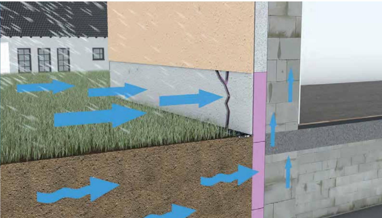
Feuchte Dämmung und schlechter Wärmeschutz im Sockelbereich müssen nicht sein. Der erdnahe Sockel bildet den untersten sichtbaren Teil einer Fassade. In der Ausführung unterscheidet man den zurückspringenden Sockel (mit Abtropfkante) und den flächenbündigen Fassadensockel.
